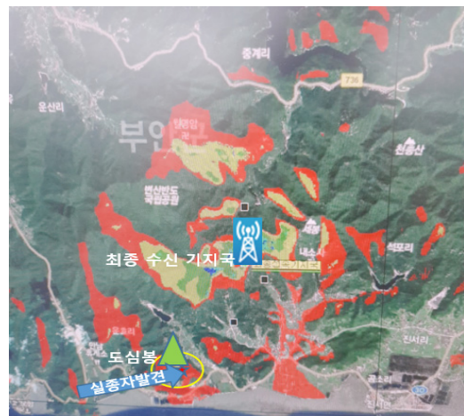
최종수신 기지국 커버리지(틸트 수정 후)
