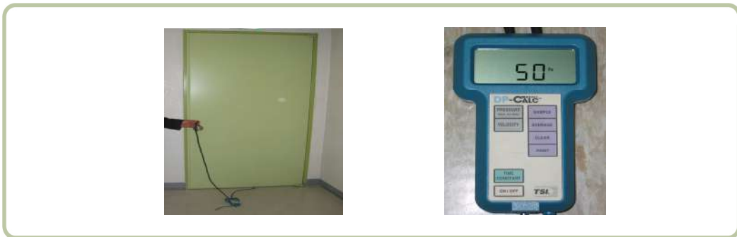
[그림 V-45] 차압계를 이용하여 차압을 측정하는 모습
