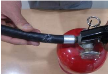
[그림 VIII-4] 호스 파손
