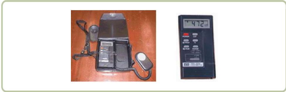
[그림 VIII-43] 측정하고자 하는 위치(지점)에 센서를 놓고 조도를 측정한다
