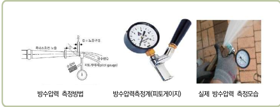
[그림 Ⅷ-14] 방수압력측정계(피토게이지)를 이용한 방수압력 측정
