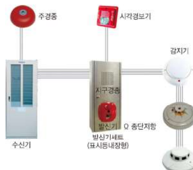
[그림 V-15] 자동화재탐지설비 구성도
