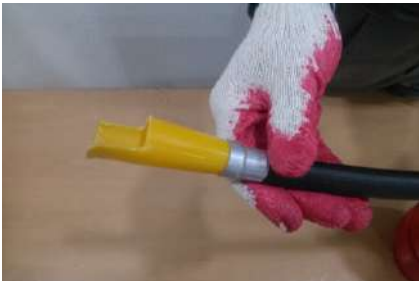
[그림 VIII-6] 노즐 파손
