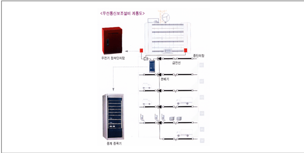
[그림 1-93] 무선통신보조설비 계통도
