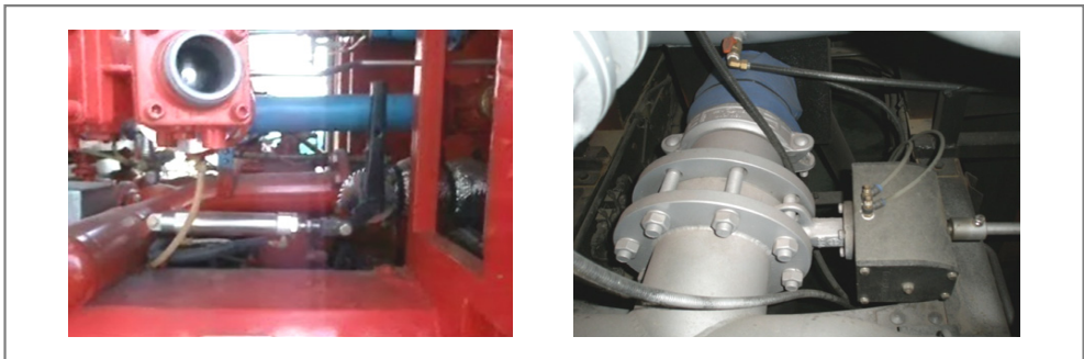
[그림 3-11] 그복동식실린더 및 밸브실린더 일체형 액추에이터
