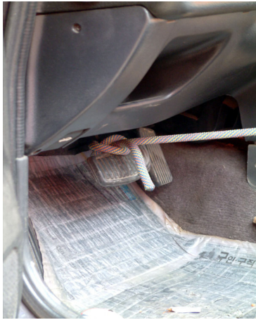
(그림 5-31) 페달에 로프를 묶고 반대쪽 끝은 창틀에 묶은 다음 문을 바깥쪽으로 젖힌다.
