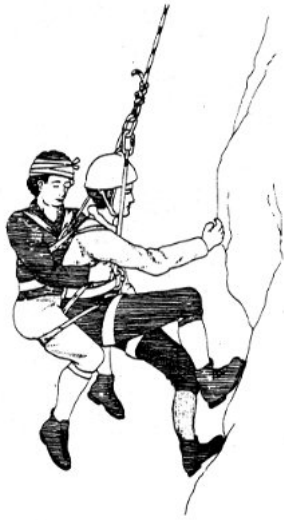
로프에 매달려서 하강하는 방법(좌), 직접 제동을 걸며 하강하는 방법(우) (그림 5-115) 요구조자 업고 하강하기
