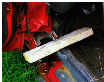
(그림 5-46) 유압램으로 프레임을 밀어내고 모서리에는 나무토막을 끼워둔다.
