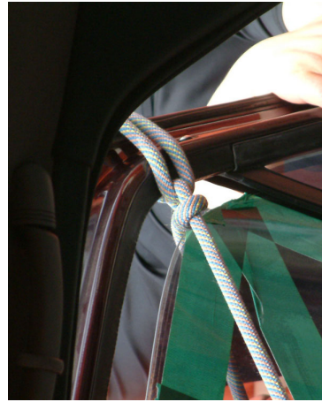
(그림 5-31) 페달에 로프를 묶고 반대쪽 끝은 창틀에 묶은 다음 문을 바깥쪽으로 젖힌다.
