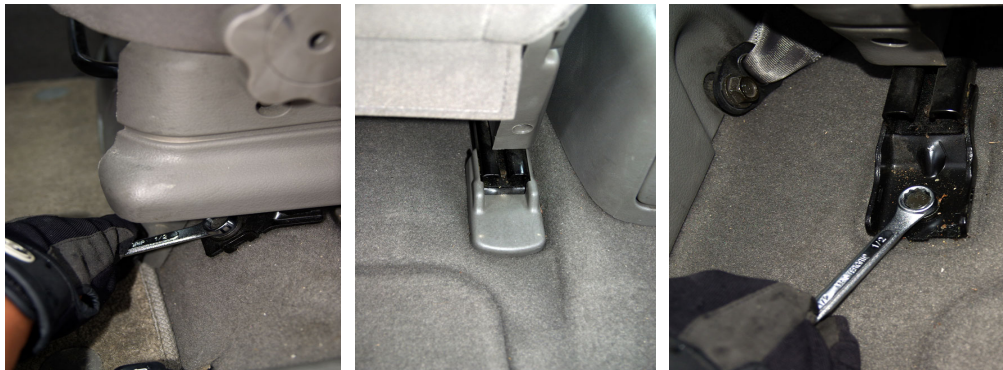
(그림 5-35) 운전석 의자를 분리하는 방법
