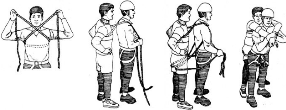
(그림 4-8) 슬링을 이용하여 요구조자를 업는 방법
