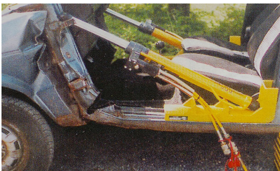
(그림 5-46) 유압램으로 프레임을 밀어내고 모서리에는 나무토막을 끼워둔다.
